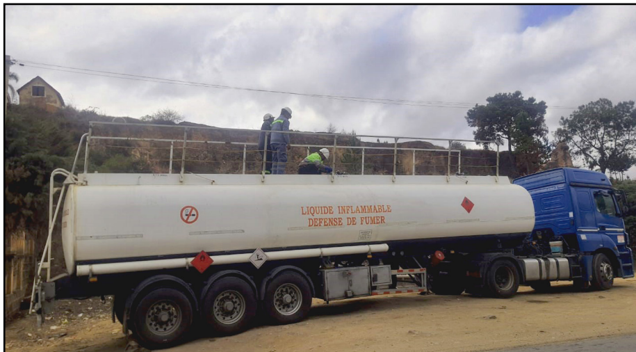
Prélèvement d'échantillon de produit pétrolier sur les camions-citerne en cours de route vers les autres dépôts de stockage, pour une analyse au laboratoire de l'OMH
